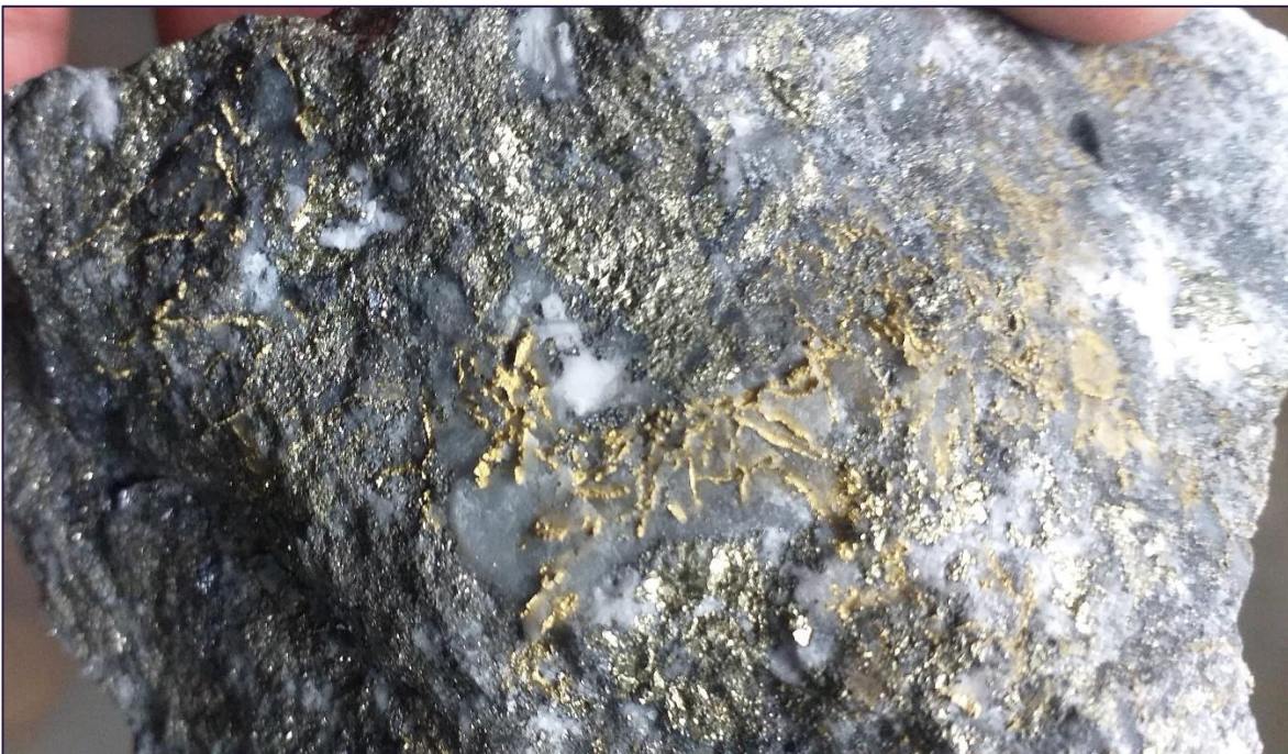
Abbildung 1. Handprobe mit hochgradigem Au in einer polymetallischen Gangmineralisierung aus dem Erzgang Tangana 1, Sohle 650 (4.650 m ü.d.M.).
